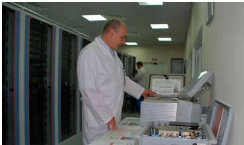
Тестирование ретранслятора сотовой связи с переносом емкости в испытательном центре ОАО «Интеллект Телеком»
